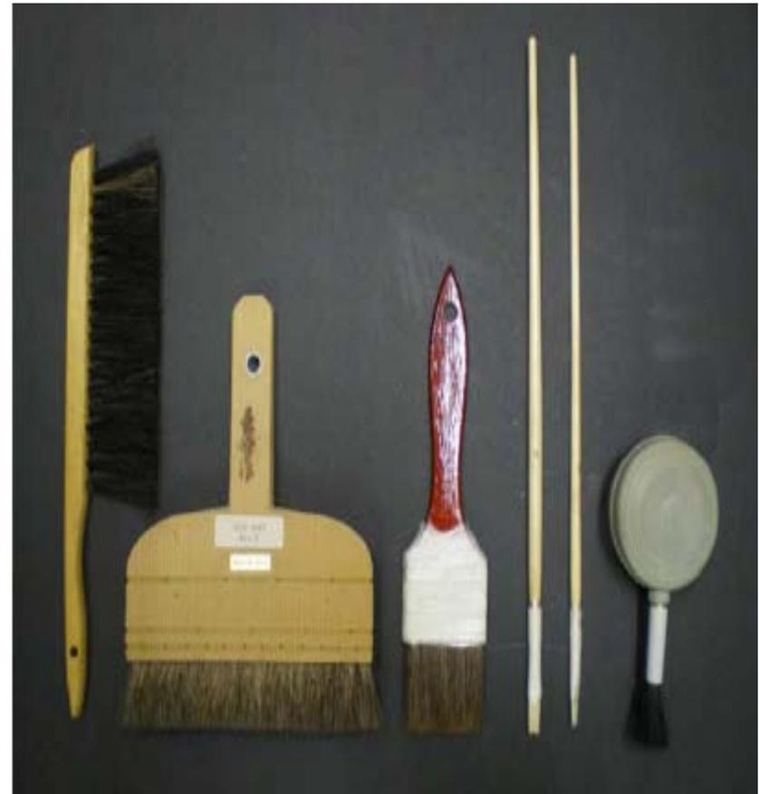
**Figura n. 1** – Tipos de pincéis, da esquerda para direita: escova com cerdas macias; pincel japonês com cerdas macias; trincha de cerdas macias; dois pincéis finos de cerdas firmes; pincel soprador.
